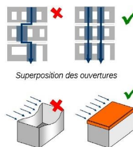
Limitation des déformations : effet «boîte»
