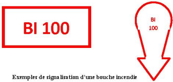
Exemples de signalisation d'une bouche incendie
