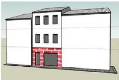
**Exemple à éviter :** Par effet de mode, certains commerces ont habillé les murs apparents de façon à imiter des façades traditionnelles sans rapport avec la structure ou avec les parties supérieures de l'immeuble (imitation des façades à pans de bois, en briques, en pierre...). Il convient dans ce cas de supprimer l'ensemble du placage et de restituer l'aspect du mur d'origine.
