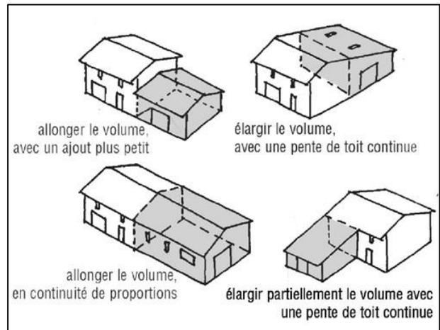
☞ Exemple de volumes en accord avec la construction préexistante (schéma).
